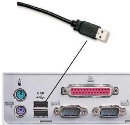
Podłączenie czytnika do gniazda komputera
